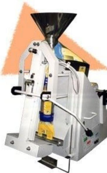
Упаковщик предназначен для упаковки дозированных сыпучих, гранулированных, кристаллических мелкоштучных продуктов и материалов в пакеты, формируемые из пищевых термосвариваемых полиэтиленовых и полипропиленовых пленок.
